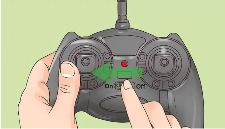
चित्र 4.1.9 रिमोट कंट्रोलर चालू करना
